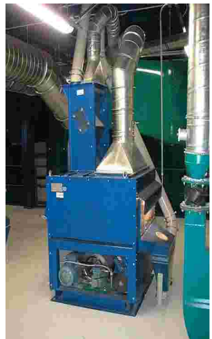
Séparation de noyaux Table de séparation densimétrique
