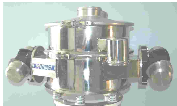
Tamiseur vibrant MC Ø400mm à entrée et sortie centrale en inox Aisi 316L, polissage miroir colle et joint FDA, Atex zones 1/21 ou 2/22
