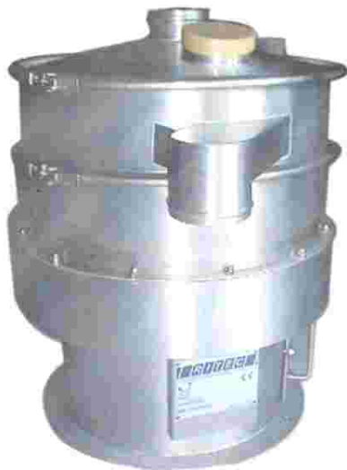
Tamiseur vibrant TN Ø600mm en inox Aisi 316L, colle et joint FDA, Atex zones 2/22
