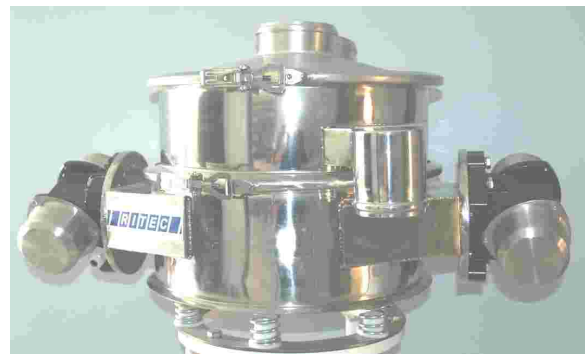
Siebmaschine MC Ø400mm Mittige Aufgabe und Auslauf, in Edelstahl 316L, spiegelpoliert FDA Klebstoff und Dichtungen, Atex Bereiche 1/21 oder 2/22
