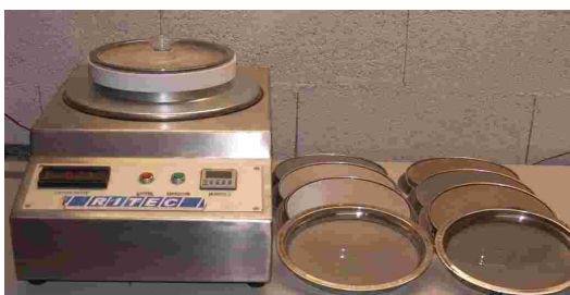
Luftstrahl-Analysesieb zur Körngrößenbestimmung und Ersatzsiebe
